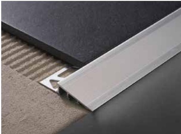
RAMPTEC ZRR ist ein Profil aus eloxiertem Aluminium für die Verbindung von Fußbodenbelägen bei Höhenunterschieden. Der Neigungswinkel von ca. 20° sorgt für eine sanfte Verbindung zwischen den verschiedenen hohen Belägen und für einen sicheren Übergang zwischen beiden Fußböden. An der senkrechten Seite ist das Profil mit einer schwabenschwanzförmigen Verankerung ausgestattet: dadurch wird eine bessere mechanische Verankerung dem Kleber und dem Stuck an den belasteten Stellen gewährleistet.
